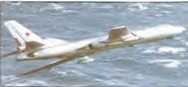
Captado en su ambiente operativo, este Tu-16 se aleja de su perseguidor. Los abombamientos del fuselaje y las barquillas subalares le identifican como un « Badger-F », usado para calibrar las defensas de la OTAN.
